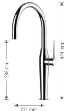
Miscelatore monocomando lavello con leva laterale e bocca girevole. Dotato di cartuccia Ø25.
