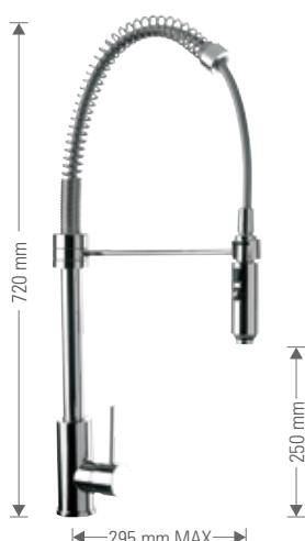
Miscelatore monocomando laterale per lavello alto, con bocca girevole a molla in acciaio inox elettrolucidato, flessibile e doccetta a due funzioni.
