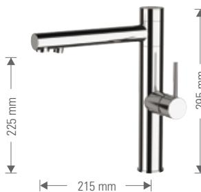
Miscelatore lavello minimale a tre vie di ingresso, bocca girevole, con selezione acqua potabile tramite pulsante ad azionamento piezoelettrico alimentato a batteria, con 2 aeratori in uscita.
