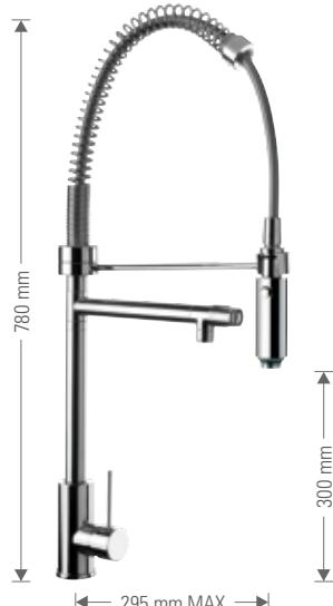
Miscelatore monocomando laterale per lavello, alto, con doppia uscita dell'acqua e comando apertura-chiusura separato. Canna girevole in ottone cromato e bocca girevole a molla in acciaio inox elettrolucidato con flessibile e doccetta ad una funzione.
