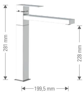
Monocomando lavello bocca girevole dotato di dispositivo luminoso AMBIENT di retroilluminazione.
