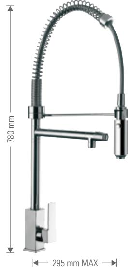
Miscelatore monocomando laterale per lavello, alto, con doppia uscita dell'acqua e comando apertura-chiusura separato. Canna girevole in ottone cromato e bocca girevole a molla in acciaio inox elettolucidato con flessibile e doccetta ad una funzione.
