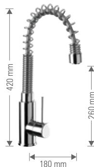
Miscelatore monocomando laterale per lavello, alto, con bocca girevole a molla in acciaio inox elettrolucidato, flessibile in acciaio inox ricoperto in pvc metallizzato e doccetta monogetto.
