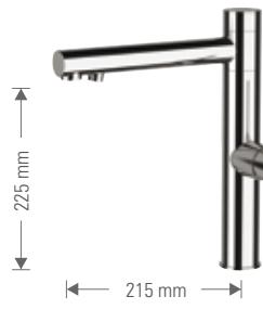
Miscelatore lavello minimale a tre vie di ingresso, bocca girevole, con selezione acqua potabile tramite pulsante ad azionamento piezoelettrico alimentato a batteria, con 2 aeratori in uscita.
