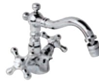
V6400 Monoforo bidet canna antica e scarico. Altezza: 14,5 cm - Interasse: 15,5 cm One hole bidet mixer with "Antique" spout and pop-up waste. Height: 14,5 cm - Interaxis: 15,5 cm.
